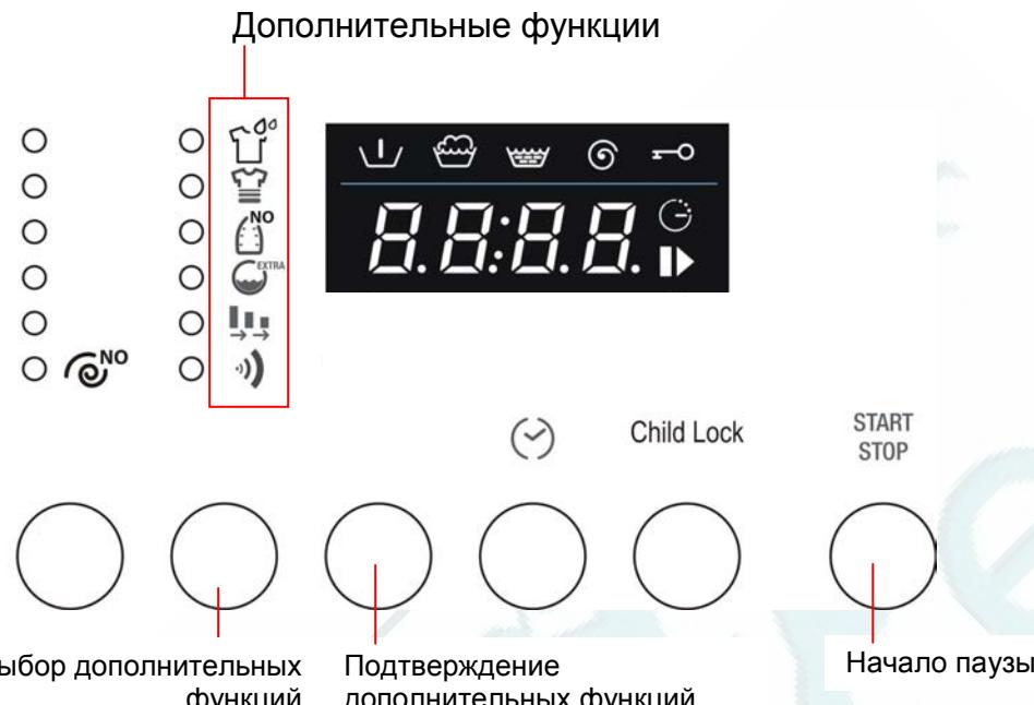
1. При помощи кнопок Выбор дополнительных функций можно выбрать в последовательности следующие функции (сверху вниз):
