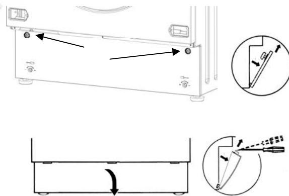
Отдельно стоящая модель - Вставьте маленькую отвертку в прорези в передней дверце плинтуса, затем слегка подденьте отверткой вверх, чтобы освободить верхнюю часть плинтуса корпуса.
