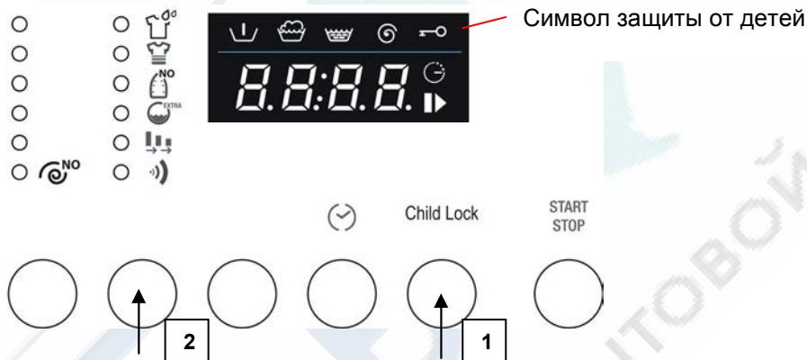
2. Для включения функции Защита от детей необходимо нажать и удерживать нажатой кнопку Child Lock (1). В течение 3 секунд нажмите также кнопку Выбор дополнительных функций (2).
